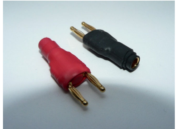
Adaptadores de 2 a 4mm, de fabricación casera, permiten conectar dos baterías LiPo en paralelo, provistas de conector de 2mm, con un variador que disponga de conectores de 4mm.
