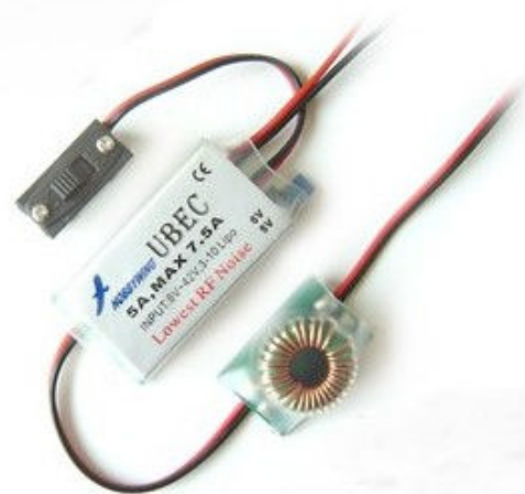
UBEC de 5A nominales. Este modelo incluye un interruptor, que resulta útil para cortar la alimentación al receptor y evitar que el motor se active accidentalmente.
