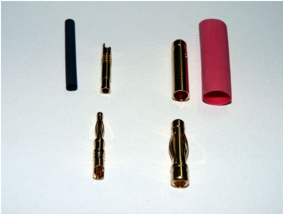
Conectores dorados redondos, tipo banana, de 2 y 4mm, con sus correspondientes aislantes de tubo de silicona termorretráctil.
