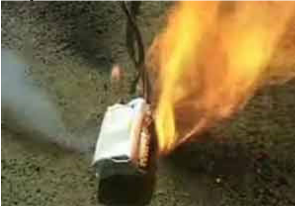
Batería LiPo ardiendo, debido a una sobrecarga
