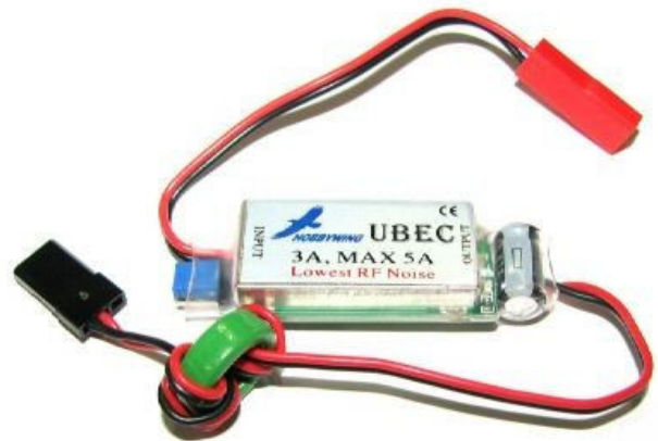
UBEC de mediana potencia, 3A nominales. El conector negro va a la posición de batería del receptor, el rojo se conecta a la batería.
